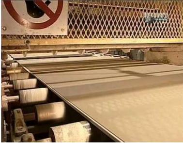
Défilement de la bande de carton sur laquelle va se poser la gâchée. La chaîne de fabrication des plaques de plâtre s'étale sur 450 m
