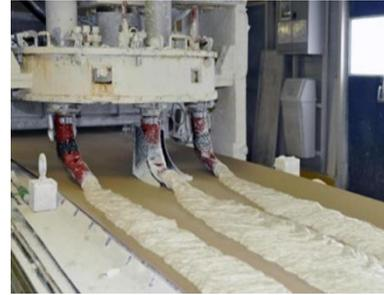
Injection du mélange plâtre, eau et ajouts spécifiques entre deux plaques de carton. La gâchée est ensuite vibrée et sa hauteur réglée suivant l'épaisseur finie de la plaque
