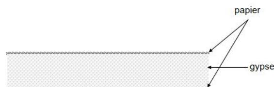
Les plaques de plâtre sont des matériaux de construction industrialisés couramment utilisés pour la finition des murs et des plafonds intérieurs. Elles sont constituées de plâtre moulé entre deux couches de carton. En usine, le plâtre gâché avec des adjuvants est enfermé dans des feuilles de carton, composant ainsi des éléments de faible épaisseur,
