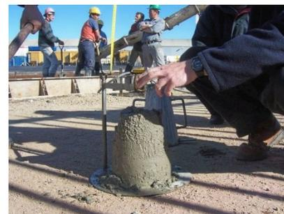
2/ Pour des bétons autoplaçants (BAP), la fluidité est mesurée par « l'essai d'étalement ». *Trois classes de fluidité*, La norme **NF EN 12350-8** décrit cet essai.
