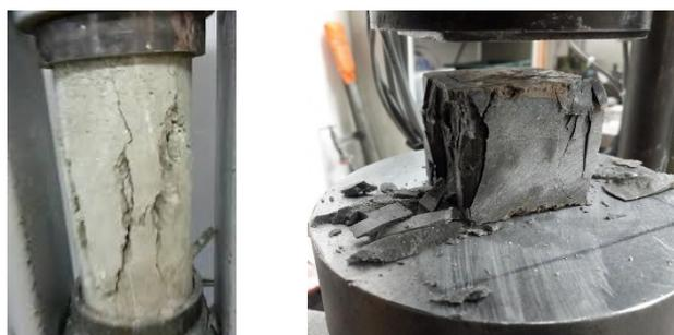
Repture des éprouvettes : dépassement de leur résistance
