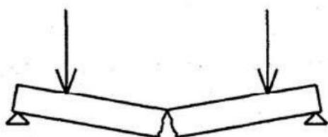
*Poutre en béton non armé*
