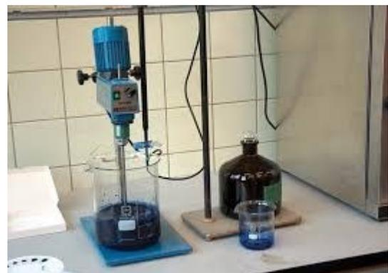
Figure I-3 Essai au Bleu de Méthylène
