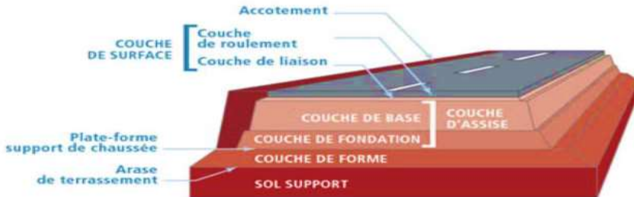
Les différentes couches qui constituent la chaussée
