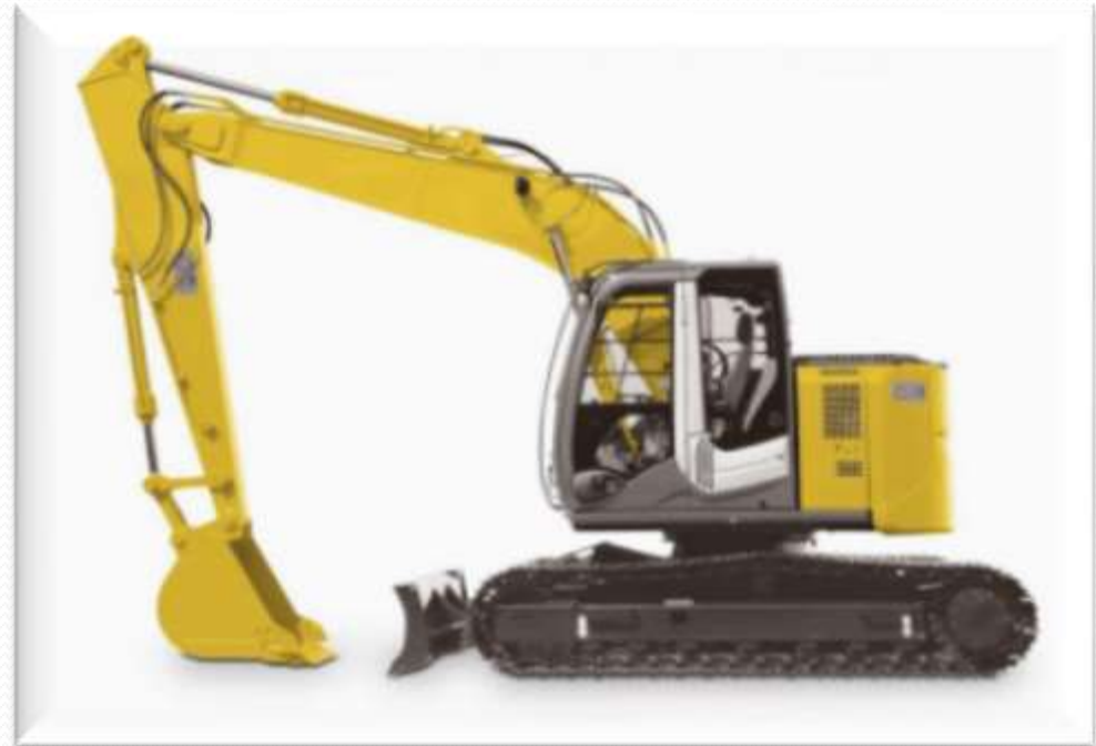
La pelle hydraulique
