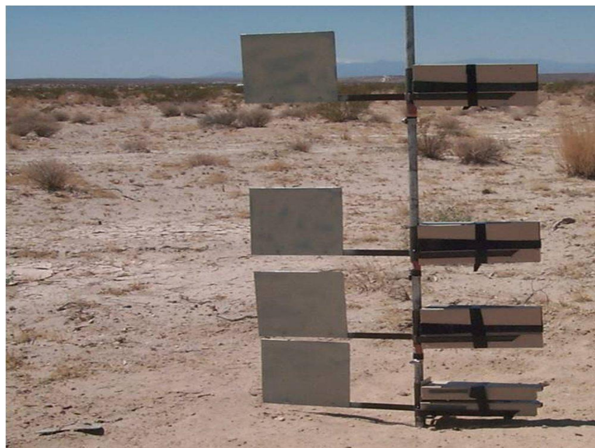
Fig. n° pièges à sable mobile de type BSNE (Big Spring Number Eight; Fryrear, 1986). C'est un instrument pour mesurer les flux de saltation. Le BSNE sont utilisé dans une configuration à plusieurs étages, les ouvertures s'orientent face
