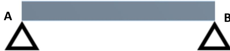
→ Question : trouver l'intensité des réactions des 2 supports simples
